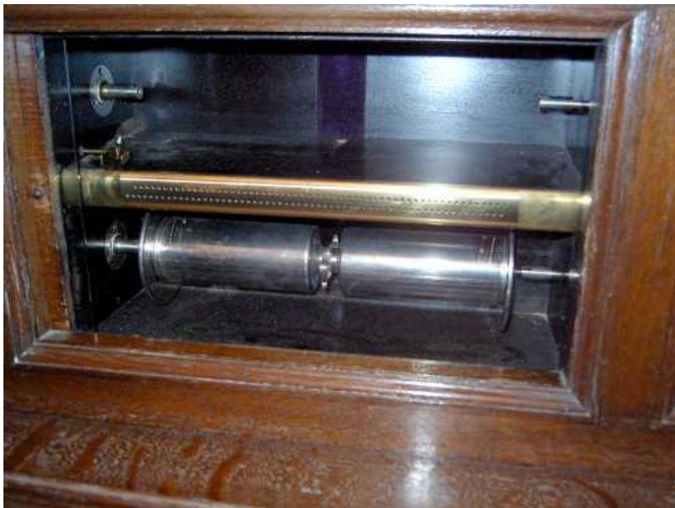
La Flûte de Pan et le rouleau receveur Notez la double perforation correspondant aux deux claviers L'espacement entre deux trous est de 1/16 de pouce
